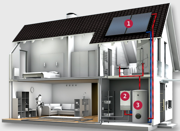
mit solarer Warmwasserbereitung
