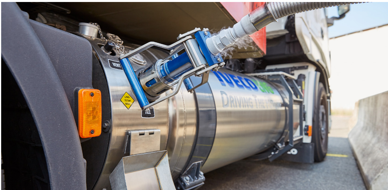
Die Betankung eines Lkw mit LNG dauert nicht länger als die Betankung eines Diesel-Lkws. | Foto: BDEW, Swen Gottschall
