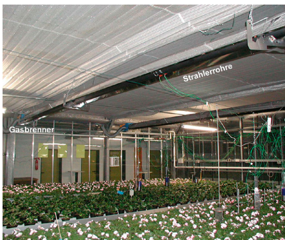
Abbildung 10: Versuchsaufbau zur Prüfung der pflanzenbaulichen Eignung von Dunkelstrahlern
