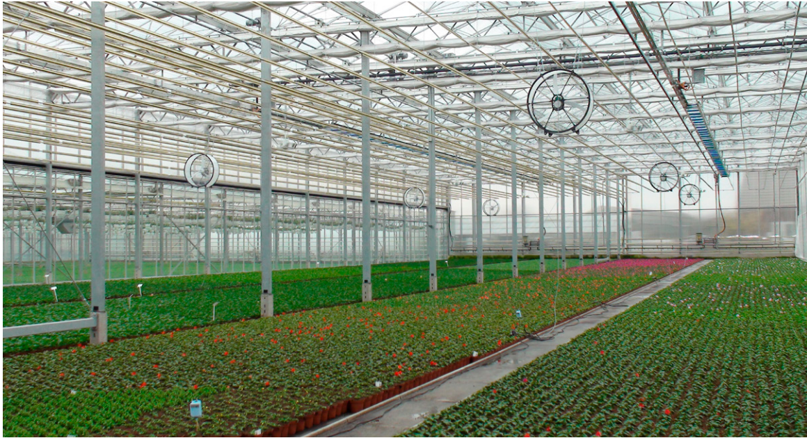
Abbildung 3: Heutige Gewächshäuser haben hohe Stehwände von 4 bis 5 m und arbeiten energieeffizient mit beweglichen Energieschirmen und Ventilatoren.
