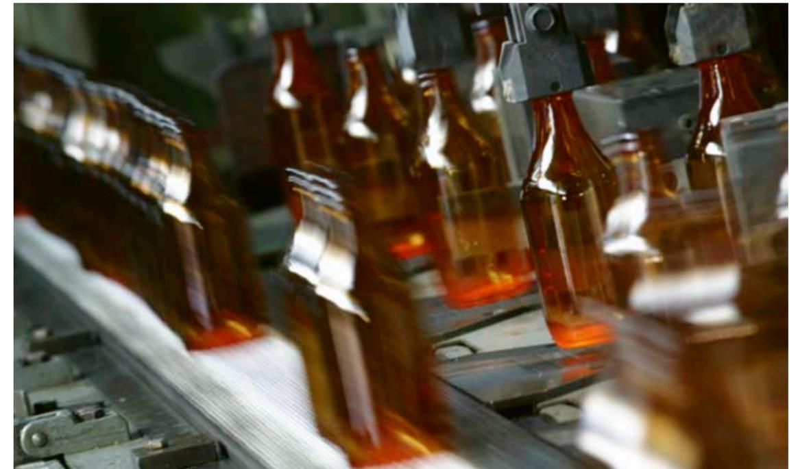
Bei der Herstellung von Behältergläsern wie Flaschen spielt die Temperatur eine entscheidende Rolle. Erdgas sorgt als Energieträger für einen besonders energieeffizienten Schmelzprozess. | Foto: Wiegand-Glas
