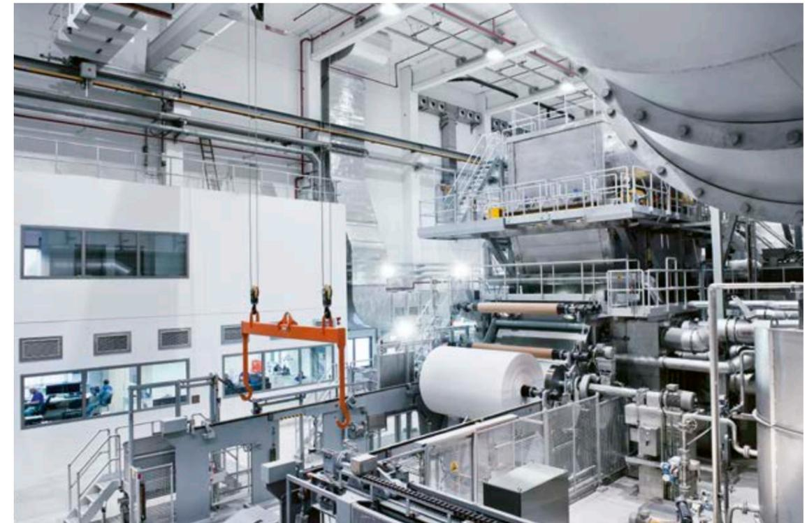
Die Papiermaschinen am Standort Miltenberg der Fripa KG nutzen Erdgas unter anderem für die Papiertrocknung. | Foto: Fripa
