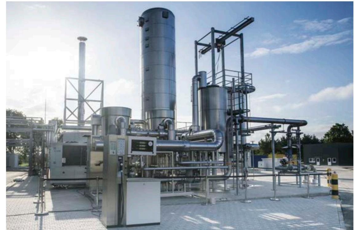
Die Power-to-Gas-Anlage in Werlte südwestlich von Oldenburg erzeugt pro Stunde 1.300 Kubikmeter Wasserstoff, der zu synthetischem Methan aufbereitet wird. | Foto: Audi AG
