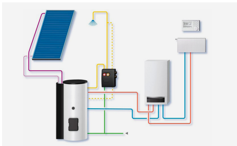
Abbildung 14: Hydraulikbeispiel Gas-Brennwertkessel mit solarer TWE
