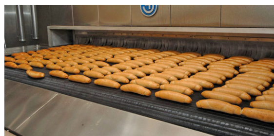
Abbildung 13: Ausgangsseite eines Tunnelbackofens
