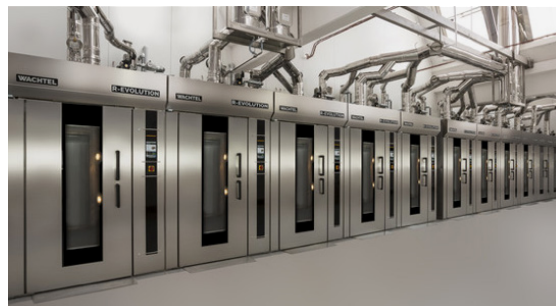
Abbildung 31: Energieeinsparung bei der Anordnung von Backöfen
